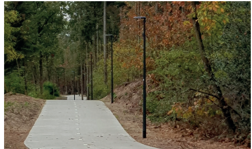
De lichtmasten zijn donkergroen (terughoudend) van kleur en geven gericht licht zodat lichtstralen niet ver het bos in schijnen, ook is er sprake van vleermuisvriendelijk licht
